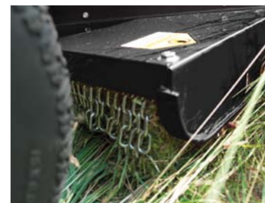
Kettingen aan voor- en achterzijde van het maaidek verbeteren het maaibeeld bij lang gras en verhogen de capaciteit.
