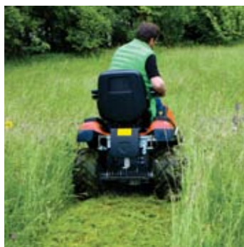
Het Hoog Gras Mulch maaidek (HGM) verandert hoge dichte begroeiing in een dunne laag mulch.
